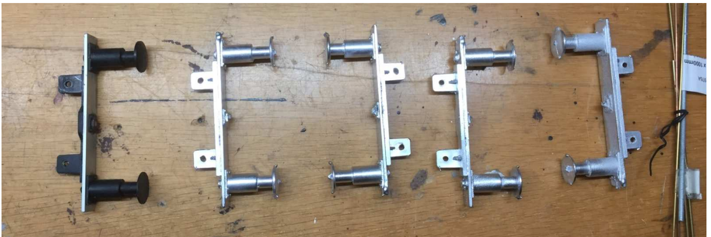
Bild 4 ) Links das Modell und rechts die Abgüsse. Diese müssen noch gefeilt und Entgratete werden. Dann wir noch ein Zugharken sowie die Lackierung erstellt.
