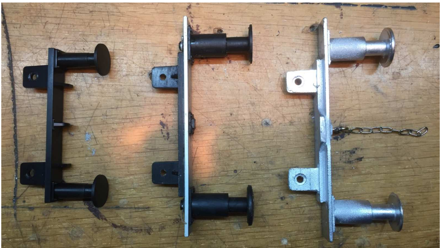
Bild 2) Auf diesem Bild sind auf der linken Seite die Piko Original Puffer zu sehen, in der Mitte ein Modell für den Formenbau um diese abzugießen und rechts die abgegossene Pufferbohle.
