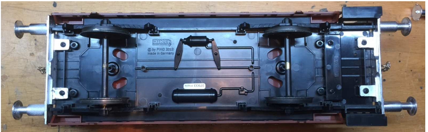
Bild 7 ) Wagen mit montierten Pufferbohlen.
